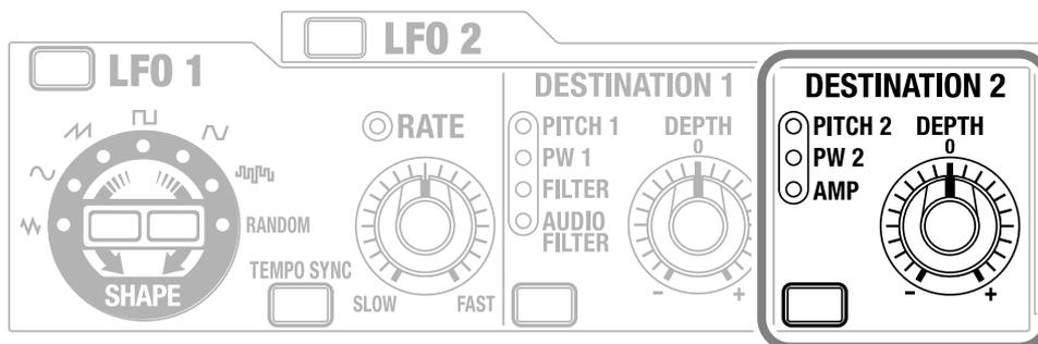
Détermine le paramètre modulé par le LFO.
