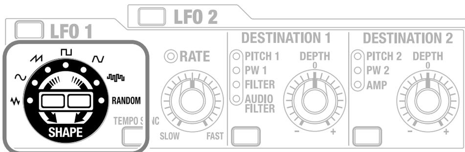
Utilisez ces boutons pour choisir la forme d'onde du LFO. Un des témoins s'allume pour indiquer la forme d'onde sélectionnée. Appuyez sur le bouton droit pour passer d'une option à l'autre dans le sens des aiguilles d'une montre ou sur le bouton gauche pour avancer dans l'autre sens.
