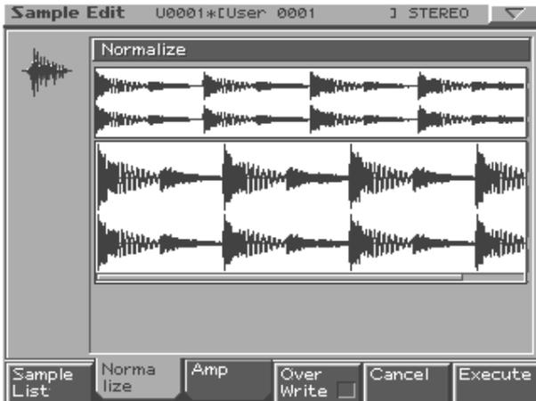
3. Pour remplacer l'échantillon actuel par l'échantillon normalisé, appuyez sur [F4 (Over Write)] pour afficher le symbole "✓".
