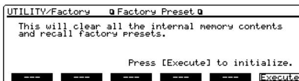
**4** Pressez [F6] (Execute) pour exécuter la procédure de retour aux réglages d'usine (Factory Preset).
