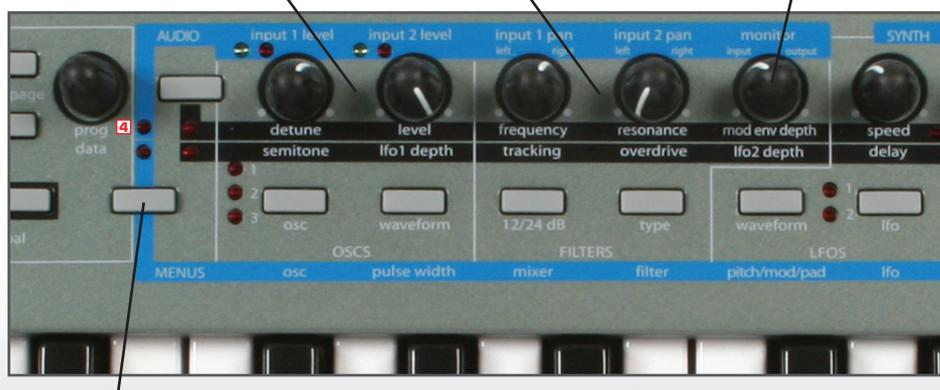
Le bouton Menus/Audio active le mode Audio (DEL 4 allumée) dans lequel les commandes servent aux réglages audio du bandeau bleu du dessus. Pressez-le une fois en mode Contrôleur MIDI ou pressez-le et maintenez-le en mode Synthé jusqu'à ce que la DEL 4 s'allume
