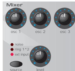
Pour que le synthétiseur présente une certaine flexibilité de manipulation, il comporte aussi une section de mixage qui permet de régler indépendamment l'amplitude (ou niveau sonore) de chacun des oscillateurs et d'en mélanger les sorties pour obtenir une forme d'onde complexe d'un point de vue harmonique.
