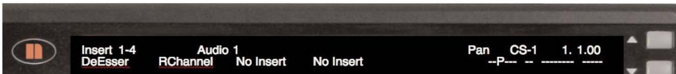
Les slots d'insert de plug-in de la piste sélectionnée sont affichés. Les slots d'insert actuellement affichés (par ex. "Insert 1-4") et le nom de la piste actuellement sélectionnée sont affichés dans la rangée supérieure et les noms abrégés de plug-in dans la rangée inférieure. Pour accéder à la prochaine page de slots d'insert ("Insert 5"), tournez le POTENTIOMETRE A 5.
