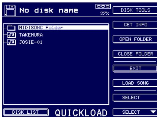
A cet endroit on peut charger des fichiers chanson MIDI dans la mémoire. Etant donné que ma fonction est à 'chargement rapide', d'autres items qui peuvent être sur le disque (ex. les multis, programmes, échantillons, etc.) n'apparaissent pas.
