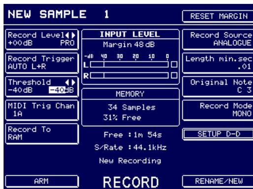
Le paramètre THRESHOLD a maintenant deux paramètres. Celui indiqué à gauche du champ est le paramètre seuil habituel qui règle le niveau de début de l'enregistrement. Le paramètre indiqué à droite est celui qui règle le niveau d'arrêt de 'auto-record'. Ils peuvent être réglés indépendamment l'un de l'autre. Pour accéder au seuil OFF, appuyer deux fois sur F4 – une fois pour sélectionner le seuil ON, une deuxième fois pour sélectionner le seuil OFF.
