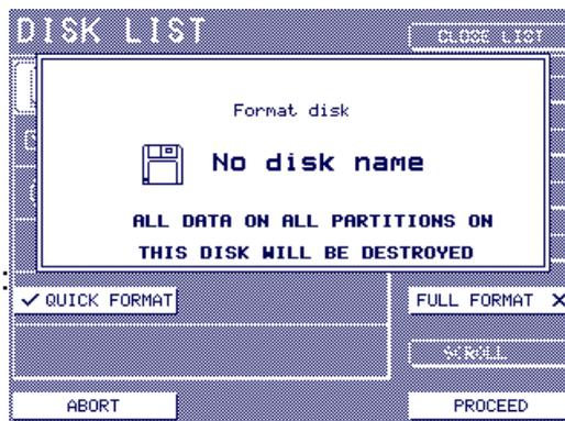
QUICK FORMAT effectue un formatage 'superficiel' et programme simplement le répertoire du disque; FULL FORMAT sera non seulement programmé sur le disque, mais de mauvais blocs seront également marqués, de sorte qu'ils ne puissent pas être utilisés. QUICK FORMAT est plus rapide, mais FULL FORMAT est plus complet, bien que plus lent. Quel que soit votre choix.....
