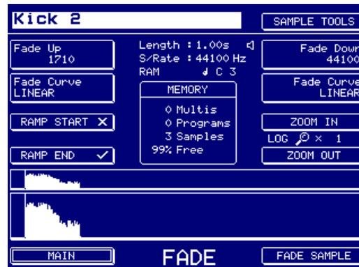
Lorsque la fonction RAMP START est désactivée (OFF) (autrement dit ) , le temps de montée du sampler est instantané (0 milliseconde), ce qui peut provoquer l'apparition de clics dans certaines situations. Si c'est le cas, activez la fonction RAMP START (ON) (c'est-à-dire ). La position par défaut est OFF ().
